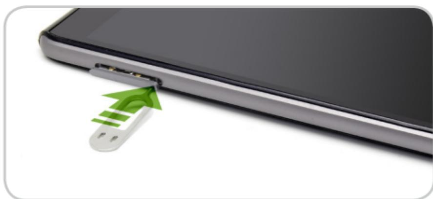
Después, con la herramienta de extracción de la tarjeta SIM o un clip, presione hacia dentro. La bandeja se abrirá.
